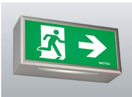
Lampada di sicurezza monofacciale per segnalazione vie di fuga costruita in profilato di alluminio anodizzato. Illuminamento omogeneo grazie all'avanzata tecnologia LED con luminanza di almeno 500 cd/m<sup>2</sup>.
