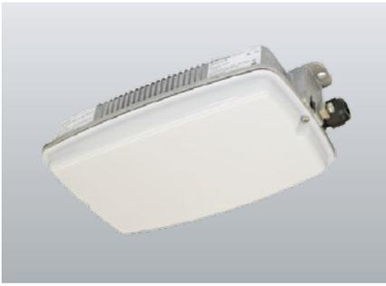
Apparecchio di segnalazione di emergenza e fuga protetto contro le esplosioni per la Zona 2, 22. Apparecchi per montaggio a soffitto o a parete. Corpo in alluminio pressofuso con staffe di montaggio stampate.
