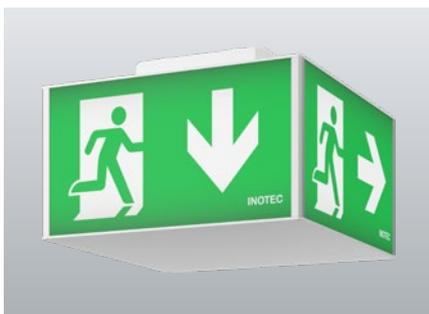
Lampada di sicurezza di forma cubica (4 facce) per segnalazione vie di fuga con profilo angolare in alluminio anodizzato e corpo in policarbonato di colore bianco resistente ai raggi UV testato al filo incandescente. Illuminamento omogeneo grazie all'avanzata tecnologia LED con luminanza di almeno; 500 cd / m<sup>2</sup> , pittogrammi personalizzabili per ciascun lato.
