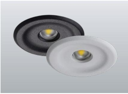
Dezente LED-Sicherheitsleuchte mit optimierter Lichtverteilung zur Ausleuchtung von Flächen. Blende aus pulverbeschichtetem Aluminium mit einem Durchmesser bzw. Kantenlänge von lediglich 45mm. Leuchte inkl. Treiber zum Einbau in Ø 38mm Deckenausschnitt. Achtung: Bei Nutzung von 230V-Versorgungseinheiten können diese nicht durch den Ø 38mm Deckenausschnitt geführt werden.
